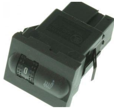
Obr. 2 Přepínač pro Škodu Fabii I
